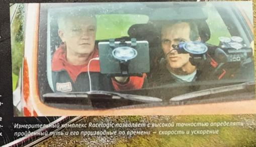
Измерительный комплекс Racelogic позволяет с высокой точностью определять проходимый путь и его производные по времени – скорость и ускорение
